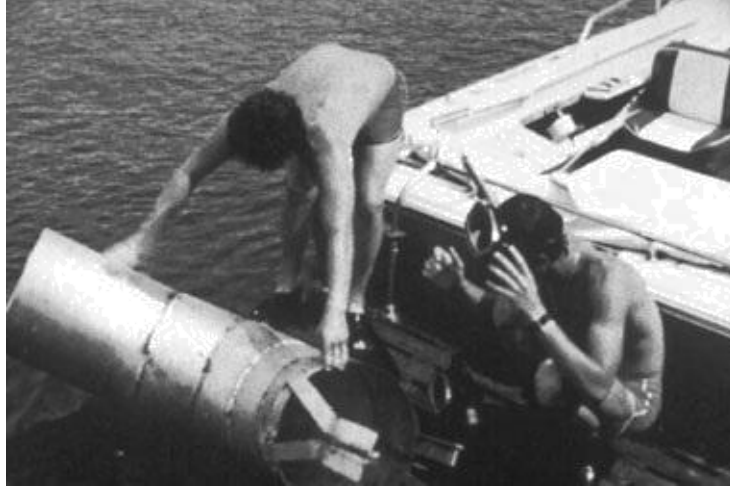
Fig. 2.2. Mike Lopez e Kenny Huertas prendendo um espanador de areia de “caixa de correio” ao suporte da hélice de nosso barco. Tiramos o pó da areia de todo o edifício de mármore em apenas quinze minutos. A explosão da hélice saiu do fundo do tubo com uma força verdadeiramente impressionante.
